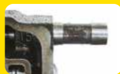
Avleiringer på ventilhus
