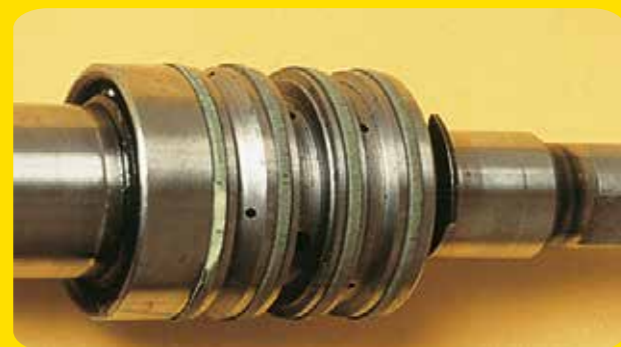
Ventilhuset med harde pakninger med sprekker
