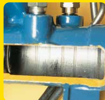
Det har blitt riper i de myke metalldelene på ventilhuset på grunn av harde pakninger
