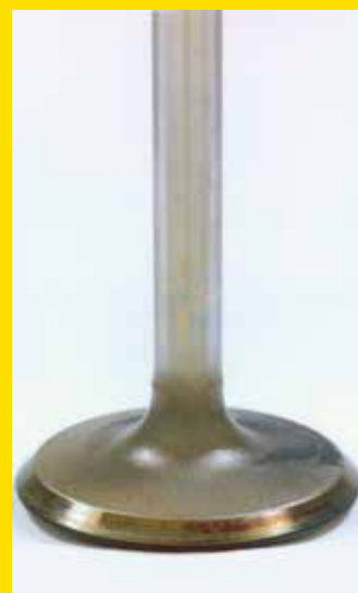
ETTER: Innsugsventilen slik den skal se ut
